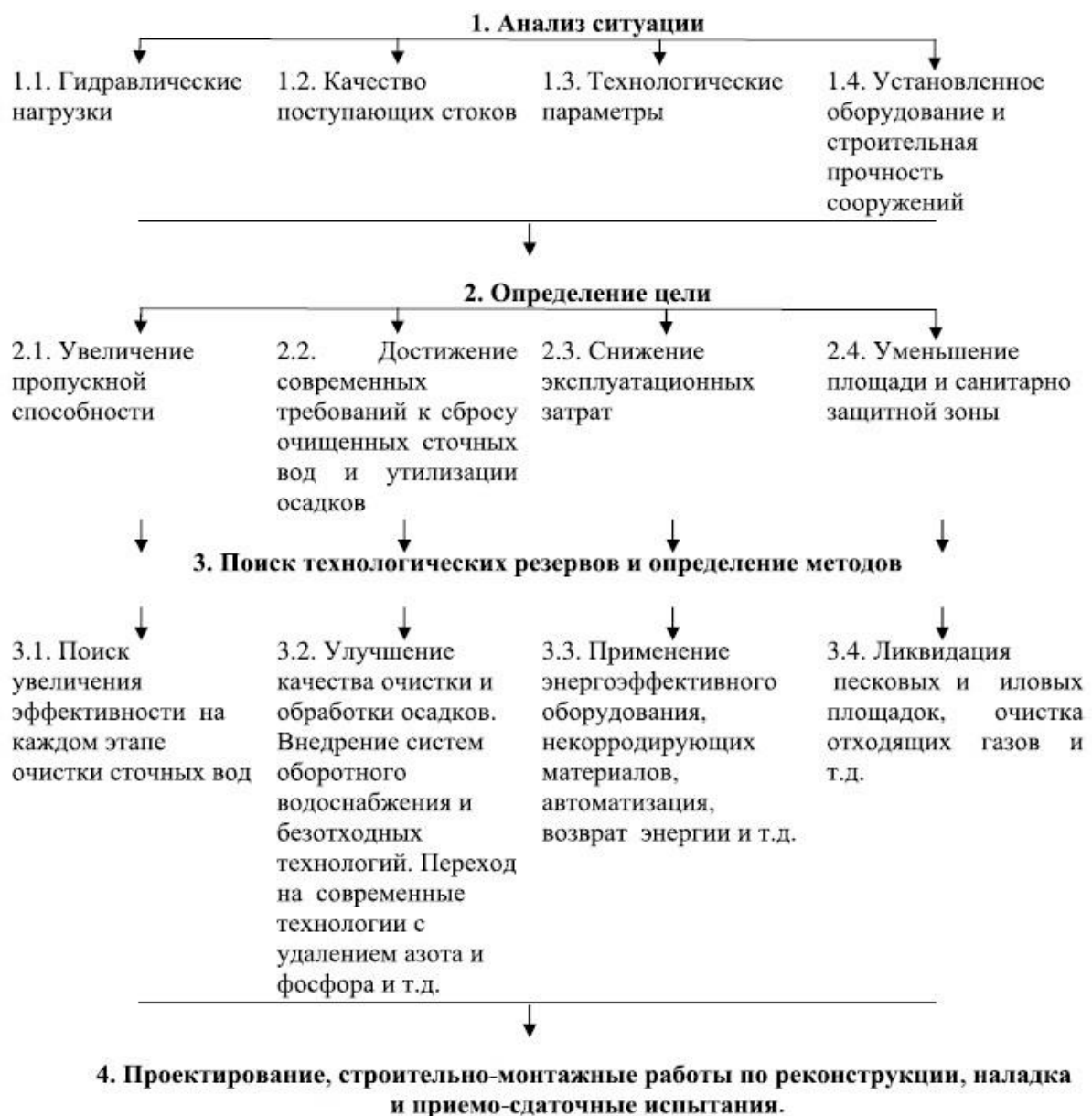
Рисунок 5 – Схема проведения работ по реконструкции и внедрению современных технологических процессов и оборудования для улучшения показателей работы существующих ОСК.
