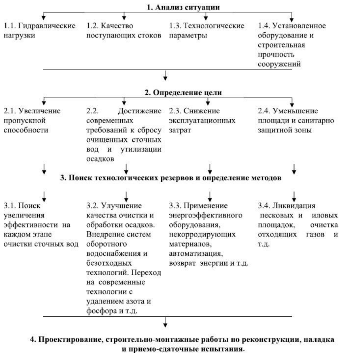
Рисунок 5 – Схема проведения работ по реконструкции и внедрению современных технологических процессов и оборудования для улучшения показателей работы существующих ОСК.
